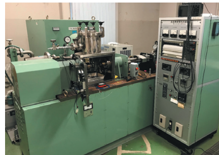
回転式高温摩擦試験機。背景温度を1000℃まで上げることができるとが最大の特徴です。
