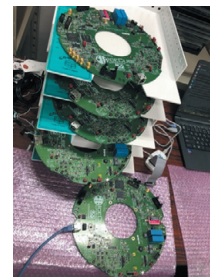
図2: 量産を見据えた基板妥当性試験のためのセットアップ
